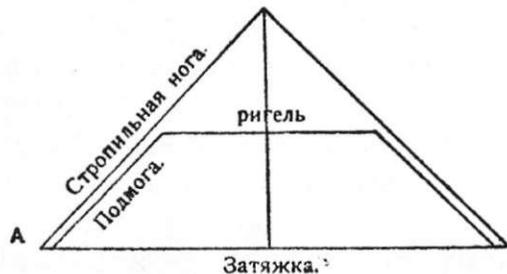
Рис. 26. Вид ригеля и затяжки.
